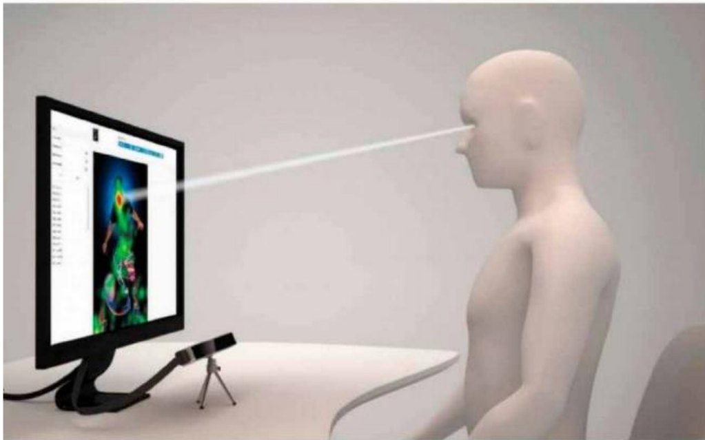
Принцип работы ай-трекинговой системы
